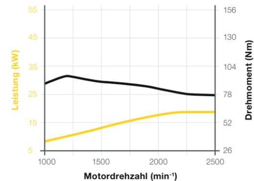
Leistungskurve Yanmar 3TNV86CT; 28,5 kW; Stufe V (Serie)
