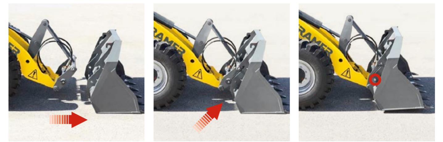
**Hydraulischer Gerätewechsel - Das Kramer Schnellwechselsystem:** An das Anbaugerät heranfahren, das Anbaugerät vom Fahrersitz aus aufnehmen und per Tastschieber am Joystick hydraulisch verriegeln. Der Verriegelungszyylinder liegt außerhalb vom Drehpunkt der Schnellwechselplatte und ist somit nicht im Schmutzbereich.
