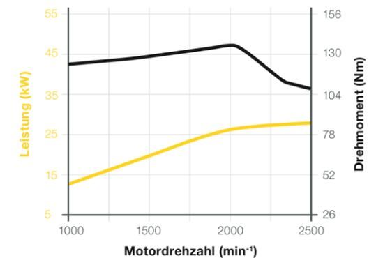
Leistungskurve Yanmar 4TNV88C; 34,3 kW; Stufe V (Serie)
