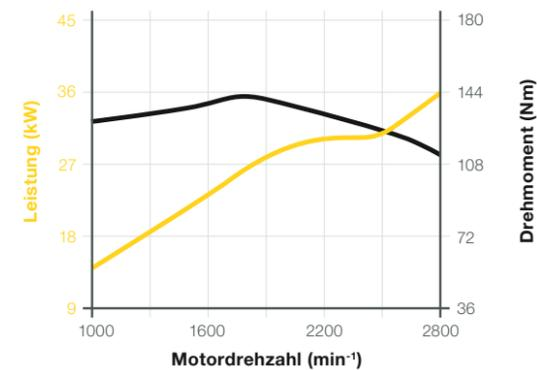
Leistungskurve Yanmar 4TNV86CT; 41,1 kW; Stufe V (Option)
