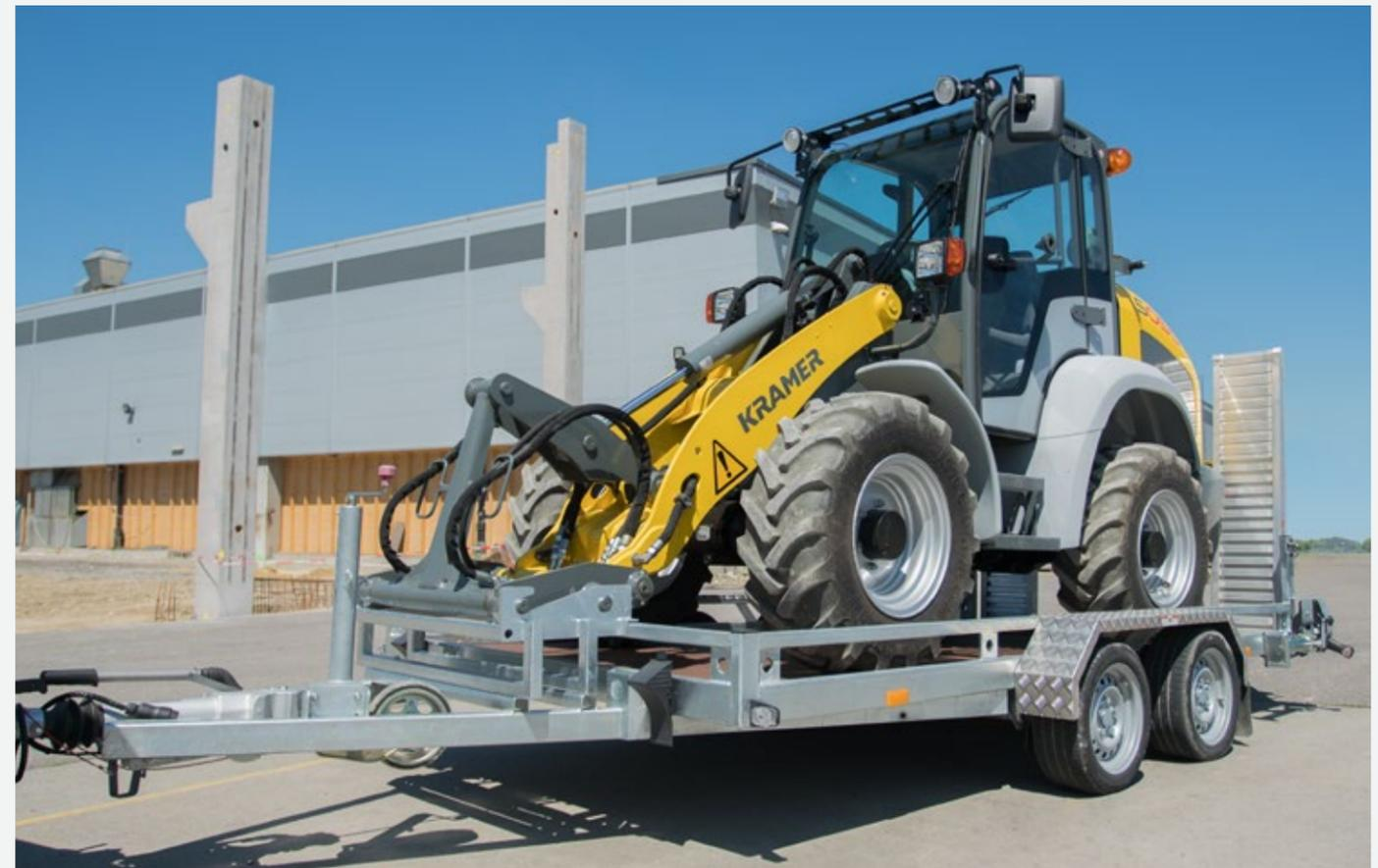
**Einfache und schnelle Ladungssicherung** durch Verriegelung der Kramer Schnellwechselladung direkt am Anhänger.
