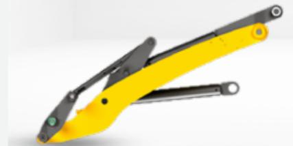
Die parallel geführte Ladeanlage gewährleistet konstante Hubkraft und eine sichere Bedienung im Materialumschlag. Durch einen Rückkippwinkel von bis zu 45° und einen Auskippwinkel von bis zu 45° verliert der Radlader im Schaufeleinsatz auch bei hohem Füllgrad kein Material und ermöglicht ein vollständiges Entleeren der Schaufel.
