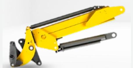
Die kompakte Kastenbauweise der Teleskopladeanlage macht die Sicht auf das Anbaugerät einzigartig. Die Vorteile der Z-Kinematik: Beim Einkippen der Schaufel wird bei gleicher Zylindergröße eine höhere Reißkraft erzeugt, da die Kolbenseite des Hydraulikzylinders beim Einkippen beaufschlagt wird.
