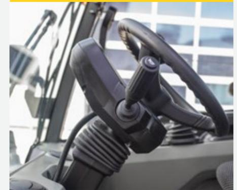
Die optionale neigungsverstellbare Lenksäule lässt sich an die Bedürfnisse des Fahrers anpassen. Das Lenkrad besteht aus einem hochwertigen und griffigen Material. Des Weiteren befindet sich an der Lenksäule ein modernes Anzeigendisplay mit automatischer Blinkerrückstellung.
