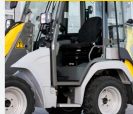
Der breite Einstieg mit zusätzlicher Trittstufe sorgt für ein komfortables Ein- und Aussteigen. Zwei an der Kabine angebrachte Haltegriffe helfen dem Fahrer sicher an seinen Arbeitsplatz zu gelangen. Des Weiteren ist die Kabinentür um 180 Grad aufstellbar und an der Maschine arretierbar.
